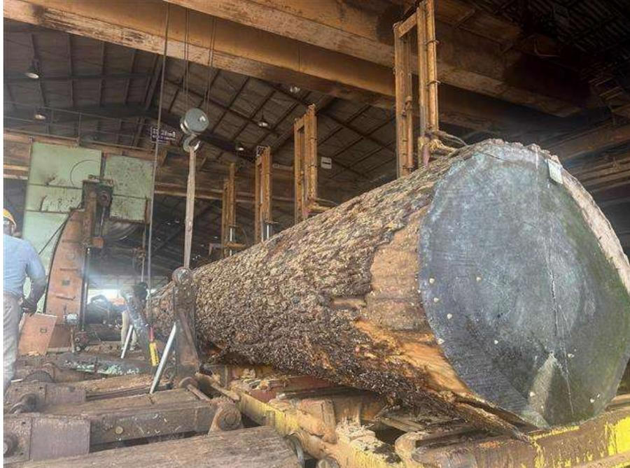
長すぎて製材所の柱にあたるので、何度もリフトを切り返し斜めにしながら製材機へセッティング。
