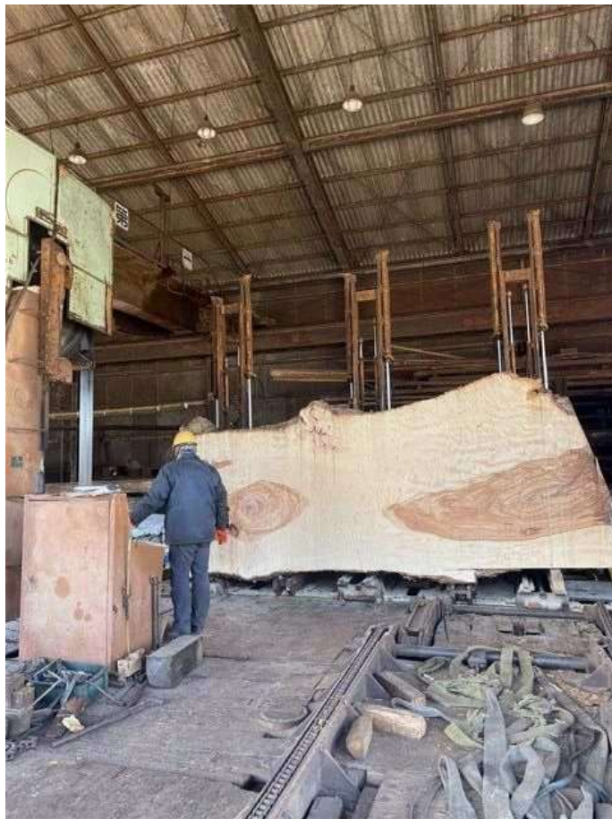
メインの一枚板部分を製材しているところ。
