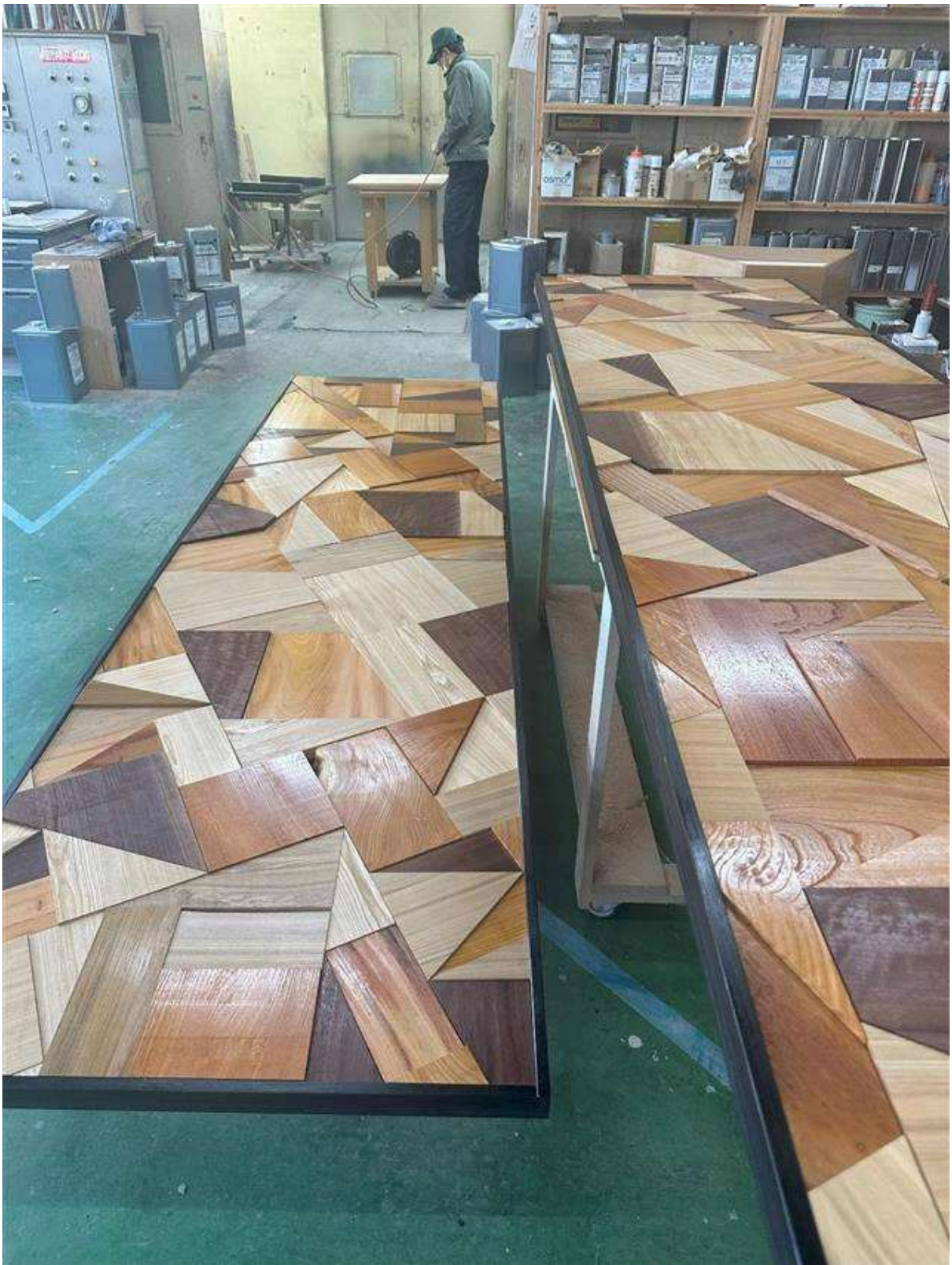
塗装中の様子です。端材を切って貼って、模様になっています。
