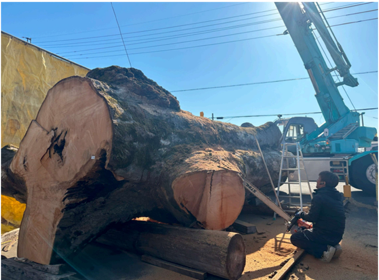
超絶ビッグなため、製材機に入るサイズにカットする「玉切り」をどうやるか仲間 間で話し合い中。
